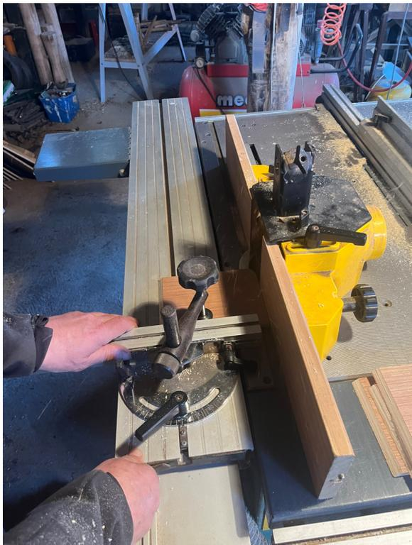
FIGURE 30 – Etape des angles à 45 degrés
